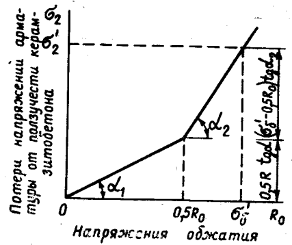
Рис. 3. Схема определения потерь напряжений от ползучести керамзитобетона в зависимости от интенсивности обжатия
